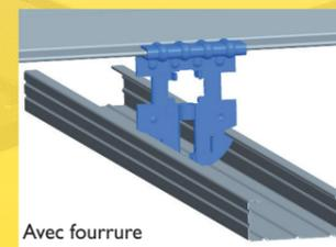
Les attaches basses peuvent être directement utilisées sous les profils. Dans le cas de plénum important, on utilisera une tige filetée avec un coulisseau ou un cavalier selon les plafonds (suspendus ou en plaques de plâtre). Les attaches basses coulisent et se fixent sur la semelle basse du profil, selon l'implantation des ossatures secondaires. Elles peuvent être utilisées en simple pièce et doivent être maintenues par une vis TRPF (voir abaques).
