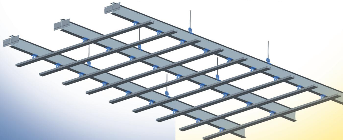
Un plafond est toujours composé d'une ossature secondaire et peut nécessiter dans certains cas une ossature primaire (charge importante, longue portée, performance acoustique ou incendie, etc...). Il supporte une charge (en kg/m<sup>2</sup>) et doit respecter des flèches maximales ainsi que des résistances admissibles sur les attaches hautes.
