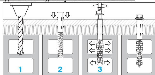
**1)** Réalisation des trous de forage sans endommager l'armature du béton et en respectant la méthode de perçage préconisée dans l'ATE. Dépoussiérage du trou.
