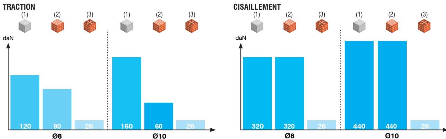
Pour les caractéristiques exactes des maçonneries et des charges de services correspondantes, se reporter à l'ETE du produit. Pour tout cas particulier, il est conseillé de réaliser des essais sur site.
