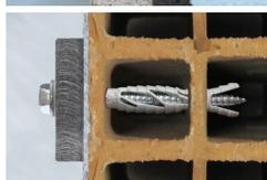
Maçonneries creuses alvéolaires (type brique « Porotherm ») : expansion de grande longueur sur plusieurs alvéoles.
