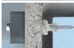
Maçonneries creuses type « parpaing creux » : expansion par « nouage » (verrouillage de forme) à l'arrière de la paroi support.
